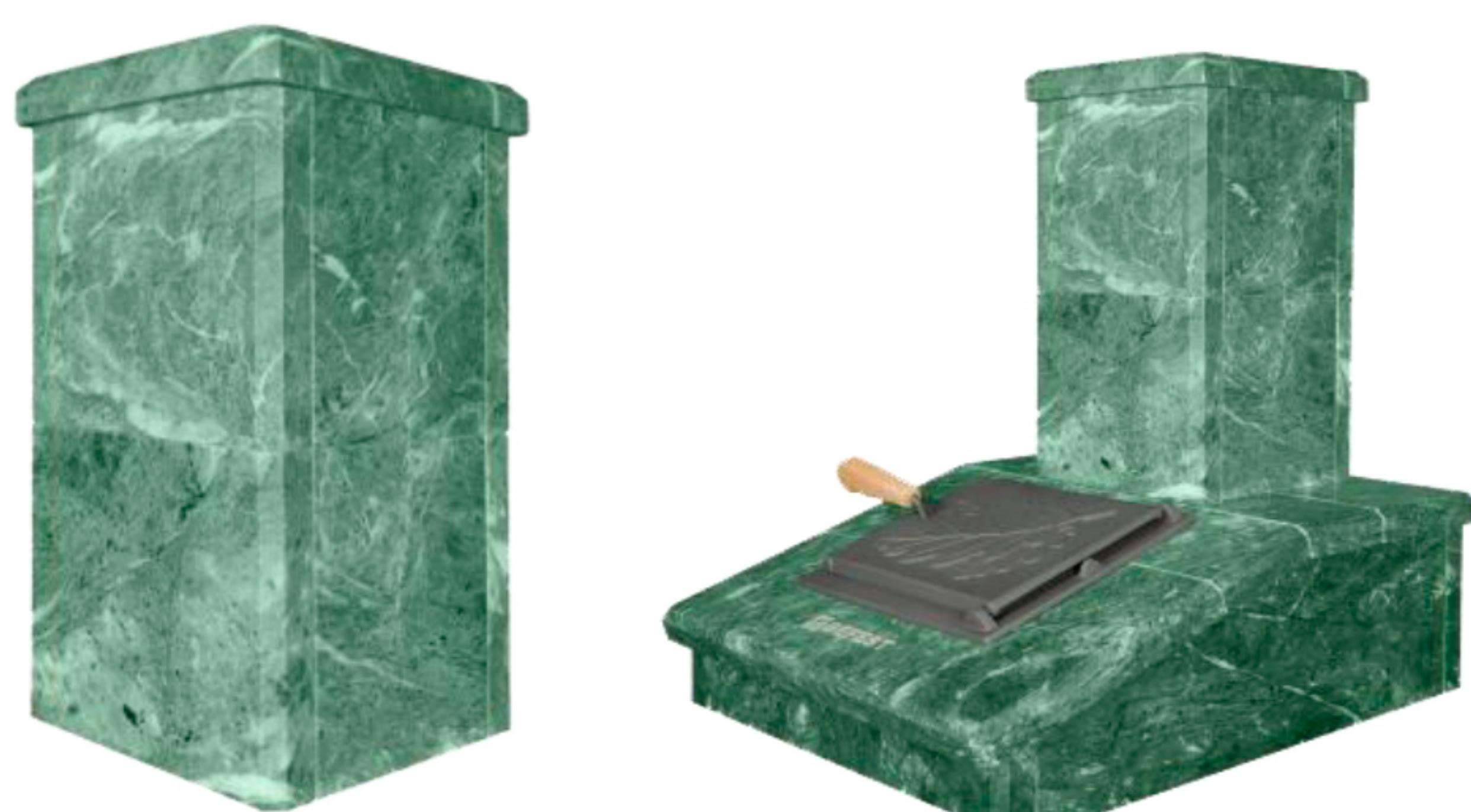
Облицовка на трубу - отдельный набор декоративных плит, предназначенный для установки на облицовку печи вокруг дымоходной трубы. Облицовка закрывает стартовую часть дымохода и адаптеры перехода на сэндвич-трубу, не только останавливая ИК излучение от разогретого дымохода но и дополнит внешний вид печи.
