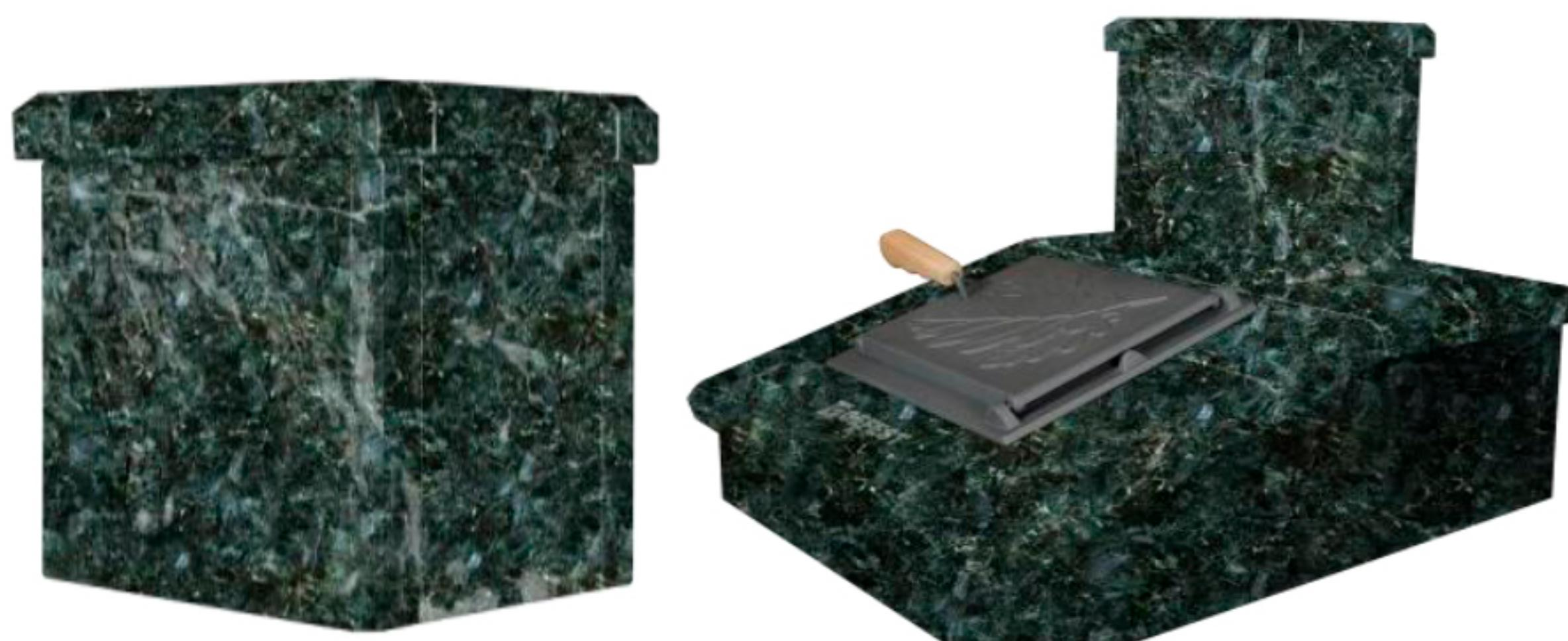
Облицовка на трубу - отдельный набор декоративных плит, предназначенный для установки на облицовку печи вокруг дымоходной трубы. Облицовка закрывает стартовую часть дымохода и адаптеры перехода на сэндвич-трубу, не только останавливая ИК излучение от разогретого дымохода но и дополнит внешний вид печи.
