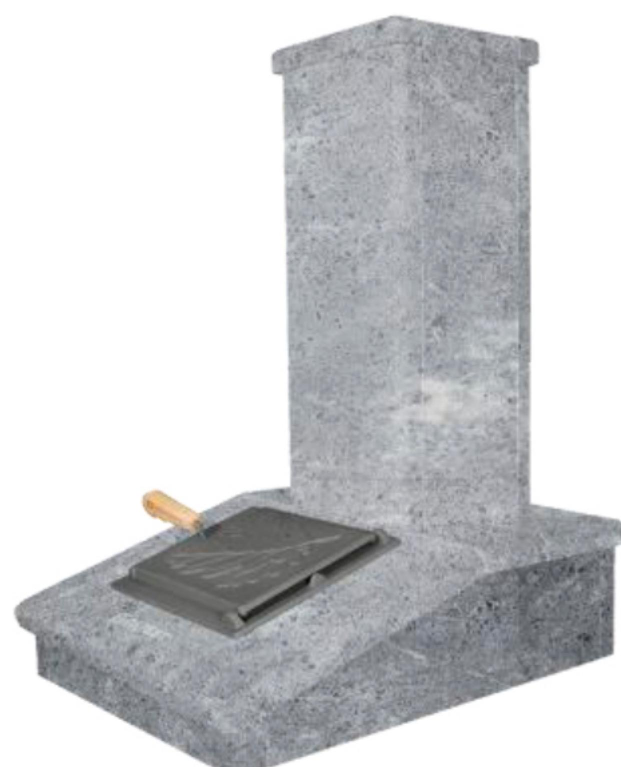
Облицовка на трубу - отдельный набор декоративных плит, предназначенный для установки на облицовку печи вокруг дымоходной трубы. Облицовка закрывает стартовую часть дымохода и адаптеры перехода на сэндвич-трубу, не только останавливая ИК излучение от разогретого дымохода но и дополнит внешний вид печи.
